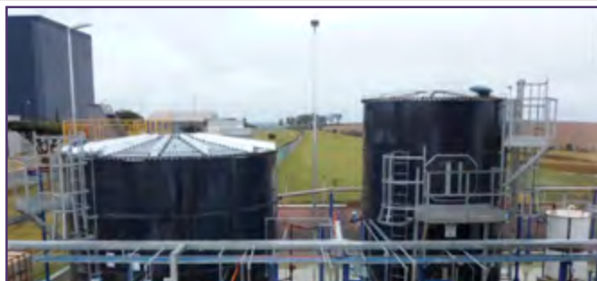
2: Techo Cónico de Viga Externa – Brasil
